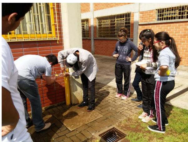
Legenda: Alunos utilizando o medidor de vazão do tipo Venturi construído por eles
